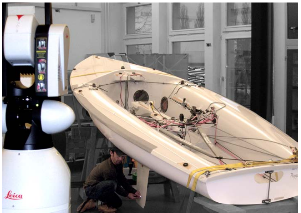
Mühsam: Vor dem Einsatz von 3D-Messtechnik musste ein Bootsrumppf in Horizontallage gebracht sein, um Symmetriewerte ermitteln zu können.
