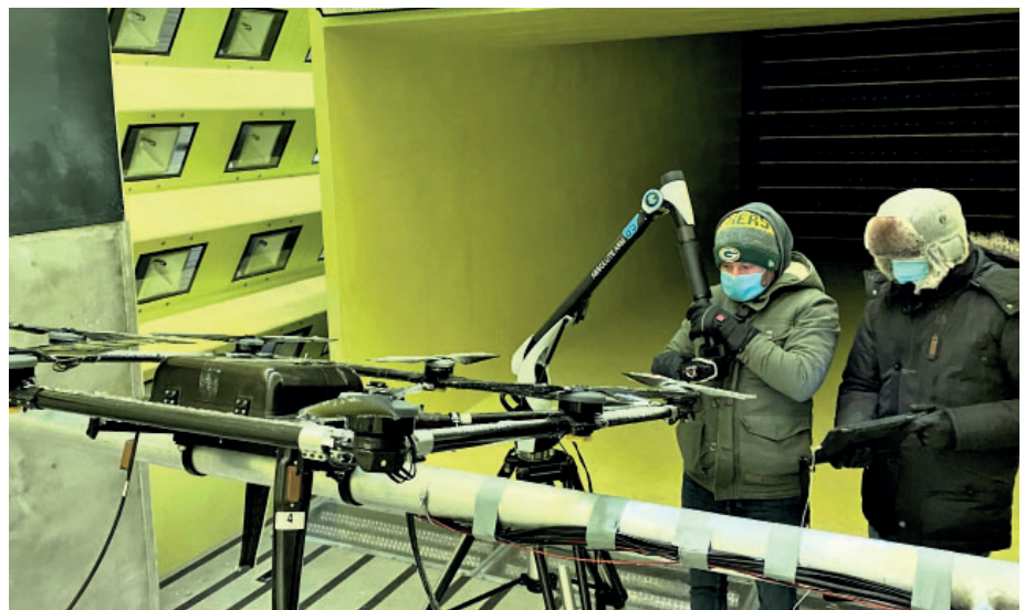
Mit Hilfe eines mobilen Messarms von HEXAGON wird eine Drohne im Vereisungskanal untersucht.
