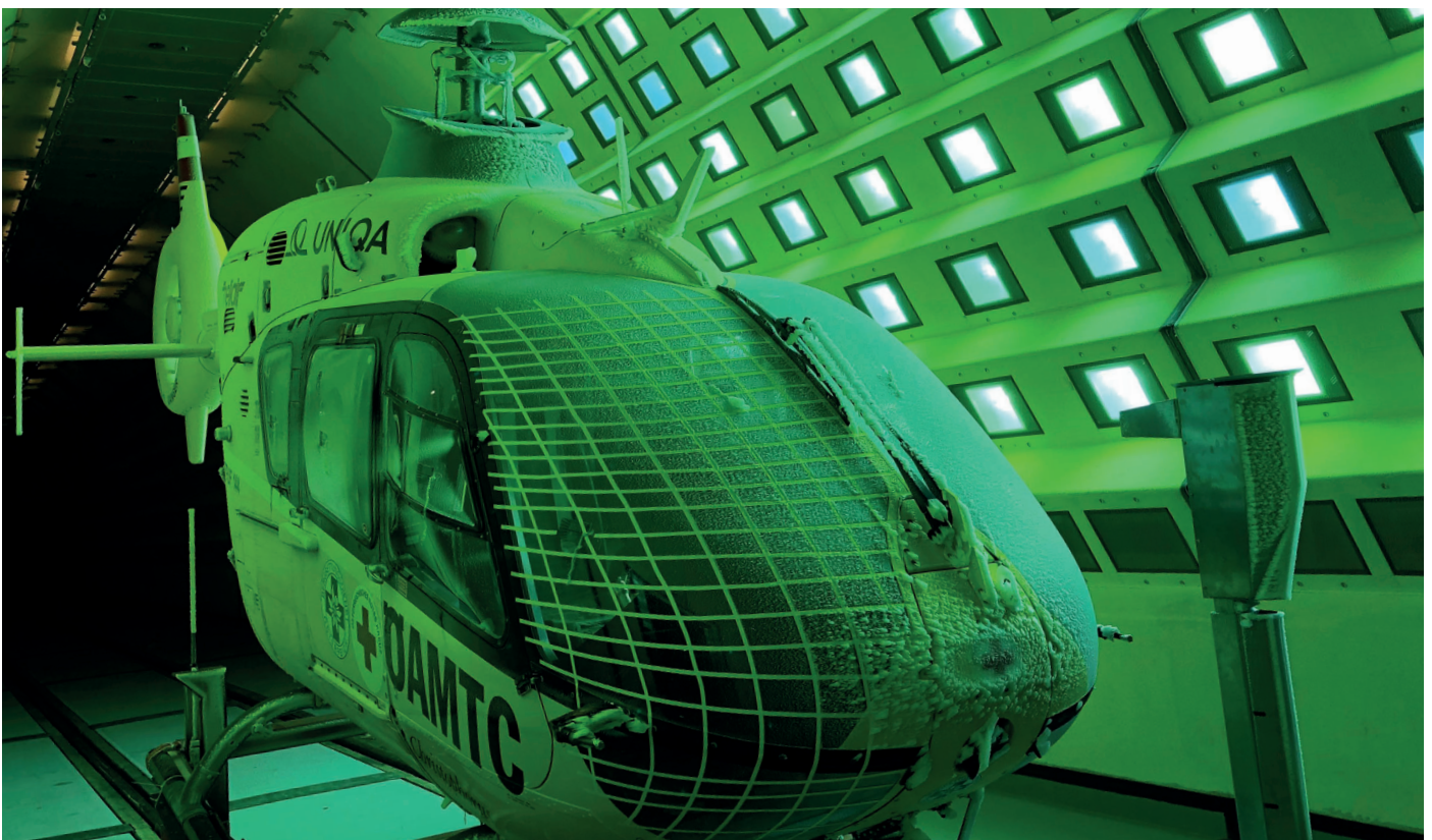
In Zusammenarbeit mit Airbus wird die Eisbildung im Vereisungswindkanal an Hubschraubern untersucht
